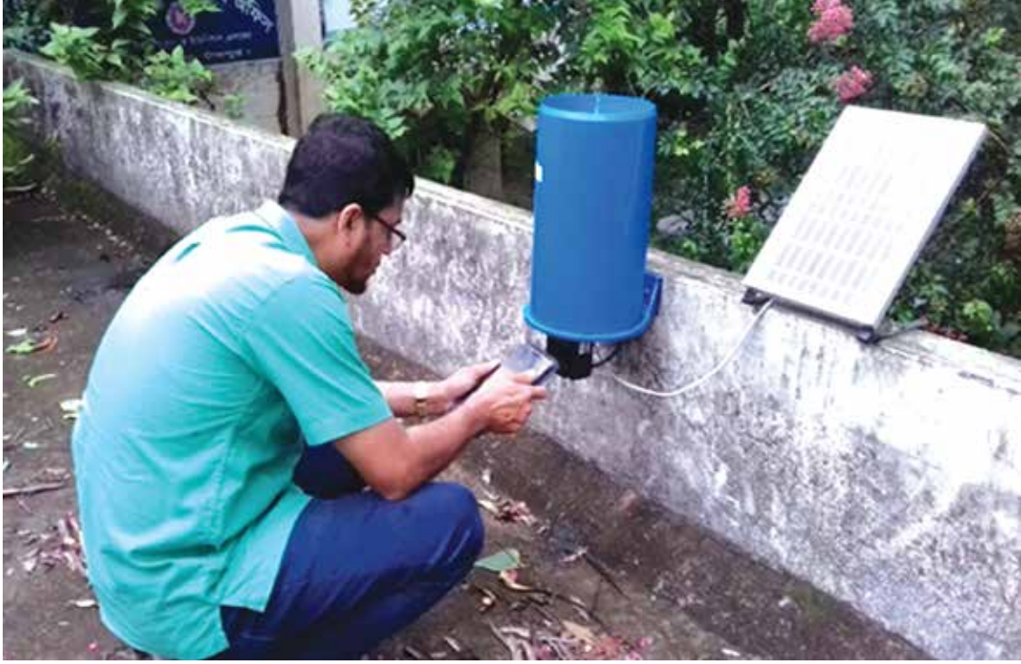
চিত্র-৫: একটি স্বয়ংক্রিয় বৃষ্টি মাপার যন্ত্র
